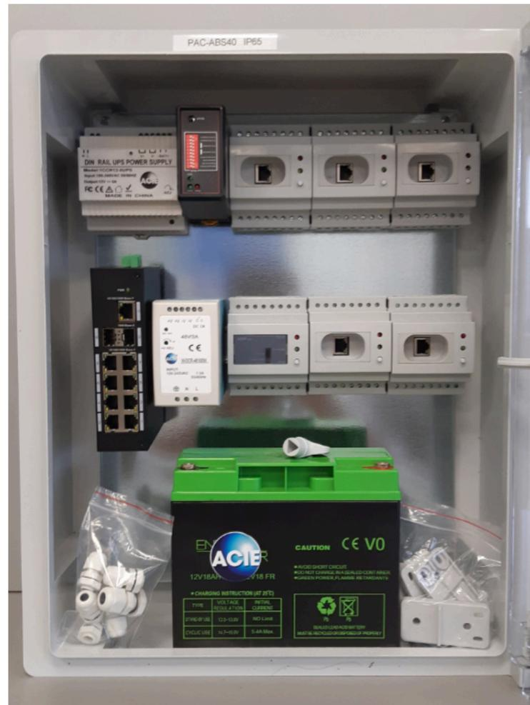
\*Photo d'illustration: exemple d'installation avec: Alimentation 12V-5a UPS, ADIP-DIN, batterie 12V - 18ah, etc (non livrés)
